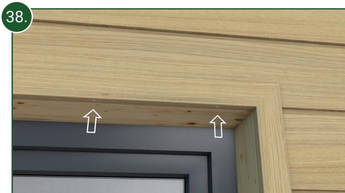
38. Im Bereich oberhalb des Fensters oder der Tür müssen im Abstand von 20 cm Entwässerungslöcher mit Durchmesser 6 mm im Abschlussprofil eingebracht werden, um einen ordnungsgemäßen Ablauf von Regenwasser sicherzustellen.
