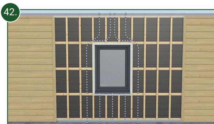
42. Die ständige Luftzirkulation verhindert somit einen möglichen Hitzestau in Verbindung mit einem Verzug der Fassadenprofile.
