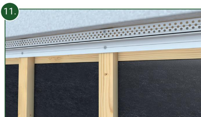
11. Verschrauben Sie nun das Unterteil des oberen Lüftungsprofils entlang des oberen Fassadenabschlusses gemäß der Skizze mit Hilfe der im Profil eingebrachten Schraubnut. Bei Fassadenverkleidungen incl. Fensterelementen siehe auch Abbildung 35!
