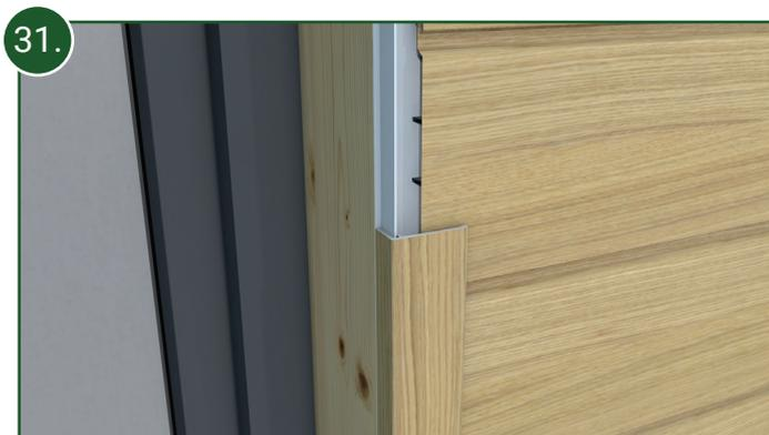
31. Montieren Sie das Oberteil des 2-teiligen Abschlussprofils exakt gleich, wie das des Eckprofils.
