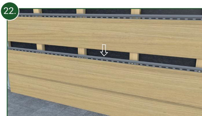
Die Fassadenprofile werden nun schrittweise aufeinandergestapelt und jeweils pro Profil nach den oben genannten Vorgaben befestigt.
