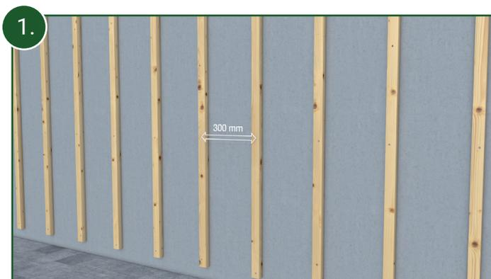
1. Schrauben Sie die vertikalen Traglatten im Abstand von 30 cm an. Wir empfehlen Dachlatten mit Maßen 40 x 30 mm. Der Abstand Unterkante Traglatte zum Boden sollte mindestens 7 cm betragen. Besonderheiten bei Fenstereinfassungen siehe Abbildungen 33 und 42.
