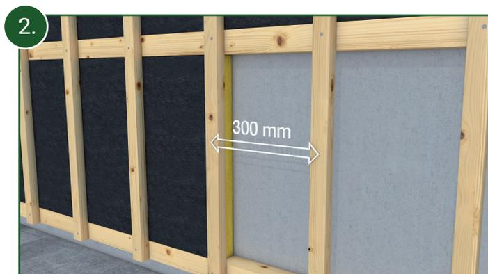
2. Bei der optionalen Verwendung von Dämmmaterial erfolgt das Anbringen der Traglatten als Konterlattung ebenfalls im Abstand von 30 cm.
