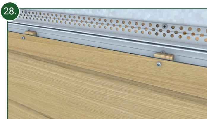
28. Anschließend wird das Fassadenprofil mit den Fassadenschrauben entsprechend fixiert. Evtl. muß das Profil an den Schraubstellen mit kleinen Holzklötzen unterbaut werden.
