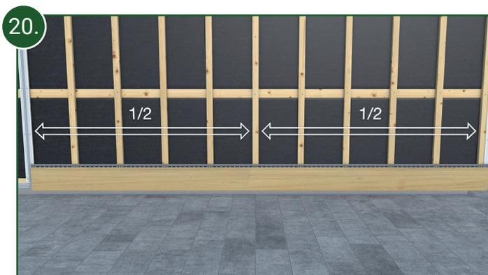
Jeweils mittig eines Fassadenprofils muss entgegen der in Bild 19 genannten Vorschriften pro Profil ein Fixpunkt gesetzt werden. Dieser Fixpunkt gewährleistet die gleichmäßige Ausdehnung der Fassadenprofile jeweils zur rechten und linken Seite.
