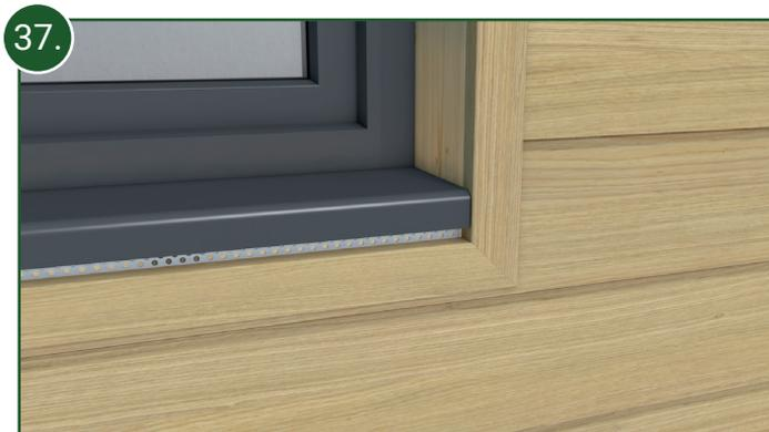
37. Sägen Sie nun die Oberteile der Abschlussprofile und des Lüftungsprofils zu (incl. Gehrungsschnitten) und klipsen diese auf die bereits montierten Unterteile. Bitte berücksichtigen Sie bei der Länge der Oberteile eine mögliche Profilausdehnung von ca. 3 mm pro Meter!
