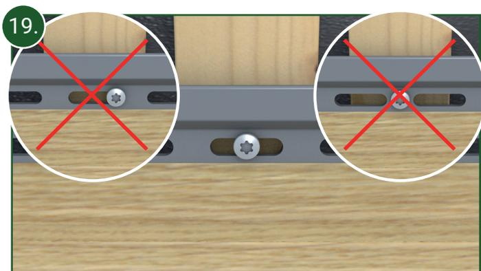
Die Positionierung der Fassadenschrauben muss möglichst mittig in den Langlöchern erfolgen. Bei ungünstigen Verhältnissen sollte die vorhandene Traglattung nochmals seitlich durch kleine Holzstücke aufgefüttert werden.
