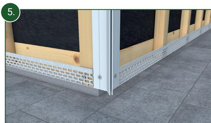
5. Verschrauben Sie nun die Unterteile der 90 Grad - Außeneckprofile in allen Eckbereichen im Abstand von 40 cm entlang der eingebrachten Schraubnuten. Hierzu muss die Auflagefläche der Unterteile vorher vollflächig durch zusätzliche Traglatten aufgefüllt werden.
