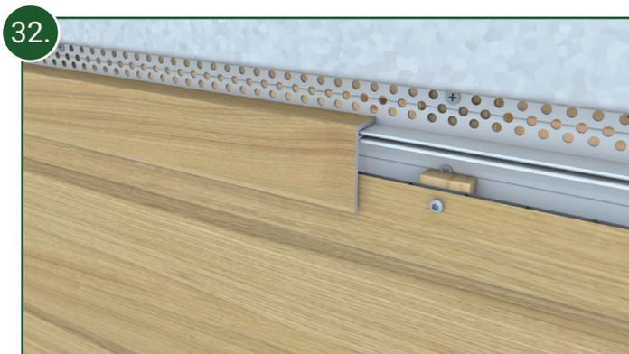
32. Das Oberteil des 2-teiligen oberen Lüftungsprofils wird exakt dem des Abschlussprofils montiert.
