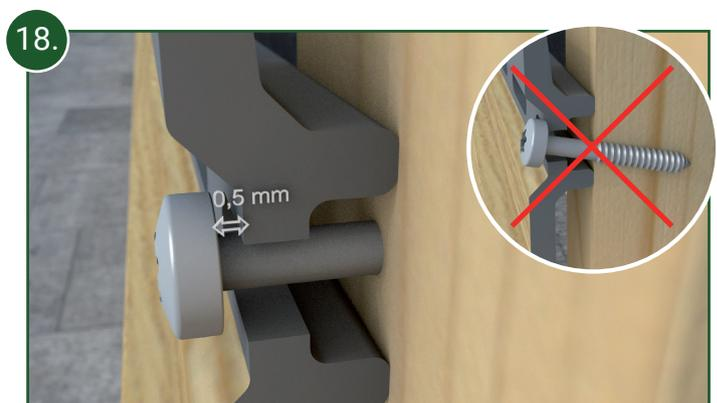
18. ACHTUNG: Die Fassadenschrauben dürfen nur so fest eingedreht werden, dass sich das Fassadenprofil nach der Verschraubung noch schieben lässt! Zudem dürfen die Schrauben nicht schräg eingebracht werden.
