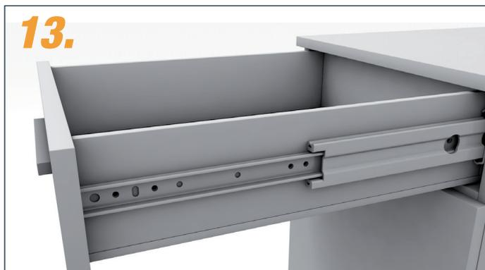
Schublade an der ausgefahrenen Innenschiene anhalten.
