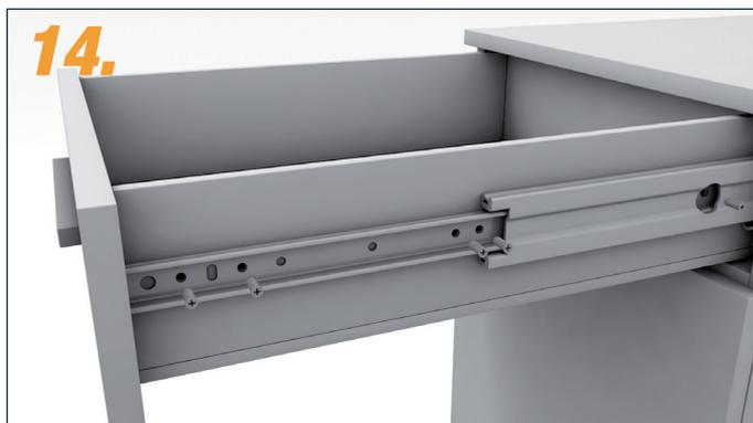
Innenschiene mit Senkkopfschrauben befestigen. Bei Metall-Korpus z.B. mit Senkkopfschraube M4x16, bei Holz-Korpus z.B. mit Euroschraube 6,3x16 oder Senkschraube 4x16 (nicht im Lieferumfang).
