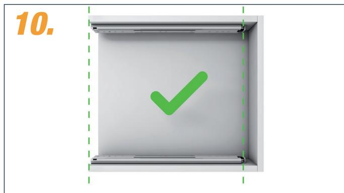
Außenschiene müssen vorne bündig und parallel verlaufen.
