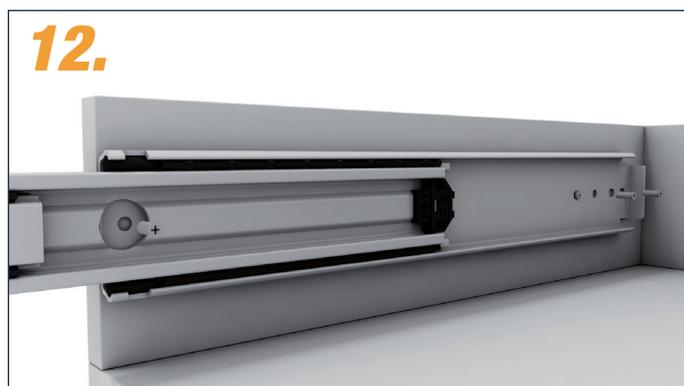
Außenschiene mit Senkkopfschrauben befestigen. Bei Metall-Korpus z.B. mit Senkkopfschraube M4x16, bei Holz-Korpus z.B. mit Euroschraube 6,3x16 oder Senkschraube 4x16 (nicht im Lieferumfang).
